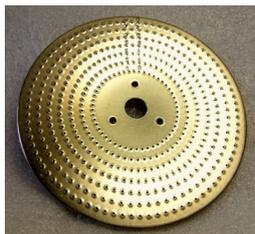
Comporte des cercles de: 50, 54, 64, 68, 70, 72 et 80 trous permettant de réaliser les divisions suivantes:
