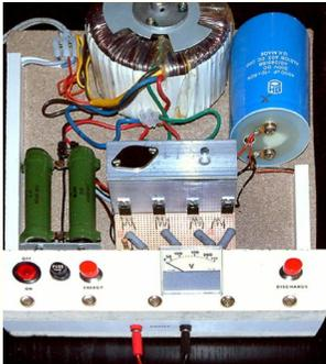
Cette alimentation (85 Volts 200 Ampères !) (photo 2) fait partie de l'équipement de mon atelier et me permet de "recharger" en toute sécurité et en adaptant sa puissance les différents types d'aimants des pendules Ato, Brillié, Bulle-Clock, Paul-Garnier...
