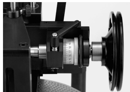
Réglage fin du quill Feineinstellung der Hohlwelle Precise set-up of the quill Reglaje fino del quill
