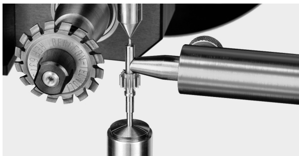
Taillage d'un pignon Fräsen eines Triebes Cutting of a pinion Fresado de un piñón
