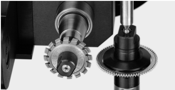
Taillage d'une roue Fräsen eines gewöhnlichen Rades Cutting of a wheel Tallado de una rueda
